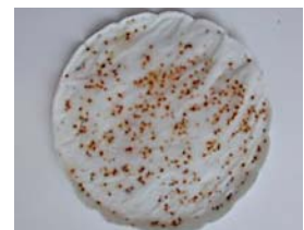
starke Abfärbung am Rosttuch
