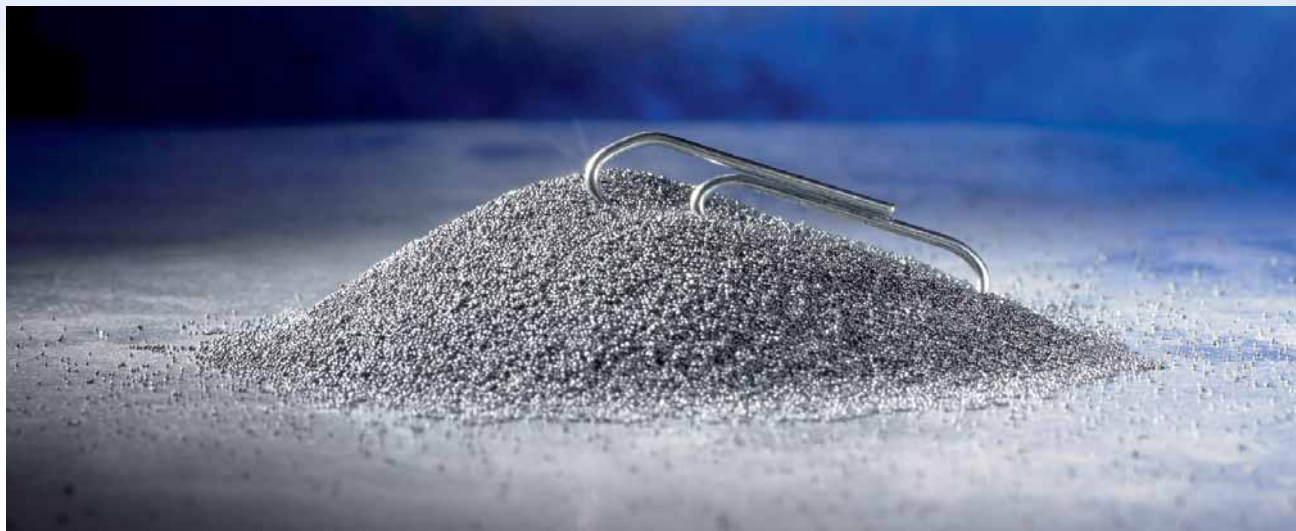
Der Kohlenstoff-Gehalt des Stahls hat einen Einfluss auf die Strahlmittelqualität.
